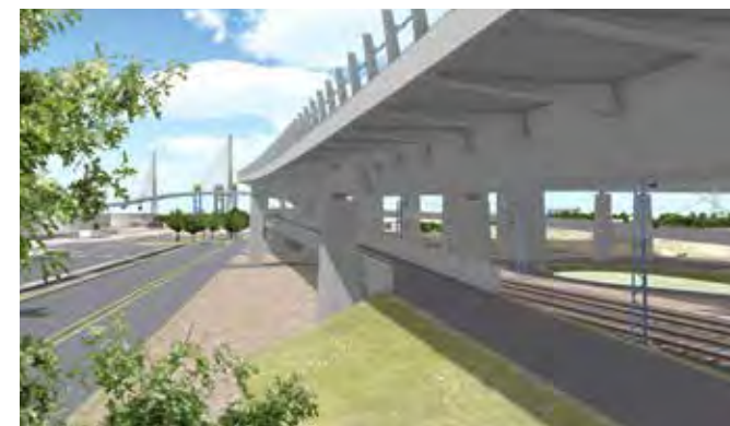
Fußgänger und Radfahrer können den Knotenpunkt unabhängig vom Autoverkehr mit einem eigenen Bauwerk über die Gleisanlagen passieren
